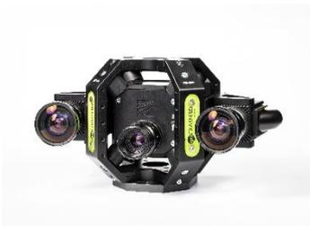
Das goCRASH3D-System erfasst mit zwei Kameras (links und rechts) und einer starken Beleuchtung (Mitte) bis zu 12.000 2D-Bilder pro Sekunde, aus denen etwa 1.200 3D-Bilder errechnet werden. © Fraunhofer IOF
