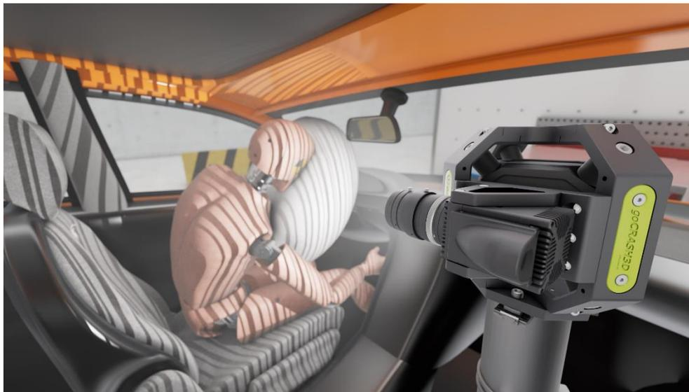
goCRASH3D (rechts) schaut mit seinen Kameras auf den Dummy. Die Auflösung der beiden 2D-Kameras ist jeweils 512 x 512 Pixel. © Fraunhofer IOF
