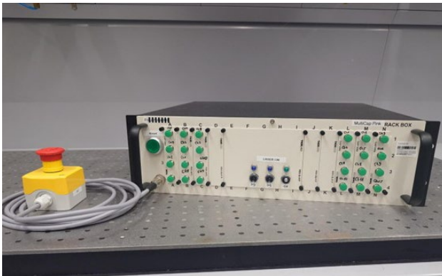
Abb. 2 Projekt Multi-Cap: Der Verstärker kann die Signale in bis zu zwölf Datenkanäle in einem Faserstrang verstärken.
