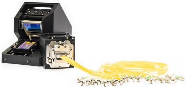
Abb. 1 Projekt WESORAM: Der Flüssigkristallspiegel (LCoS, Liquid Crystal on Silicon) splittet die Frequenzen der Datensignale auf und verteilt die Signale flexibel auf verschiedene Ausgangsleitungen.
