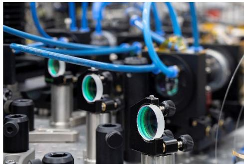
Laserausgang und Spiegel zur Strahlführung von drei Hochleistungs-Laserstrahlen. © Fraunhofer IOF
